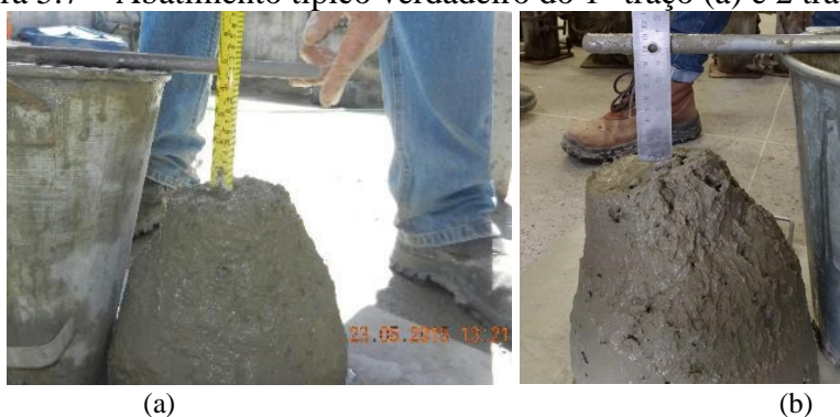
Figura 5.7 – Abatimento típico verdadeiro do 1º traço (a) e 2 traço (b)
