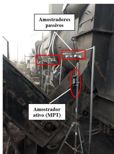
Figura 6: Amostragem de NO 2 , SO 2 e Material Particulado Total (MPT) na usina.
