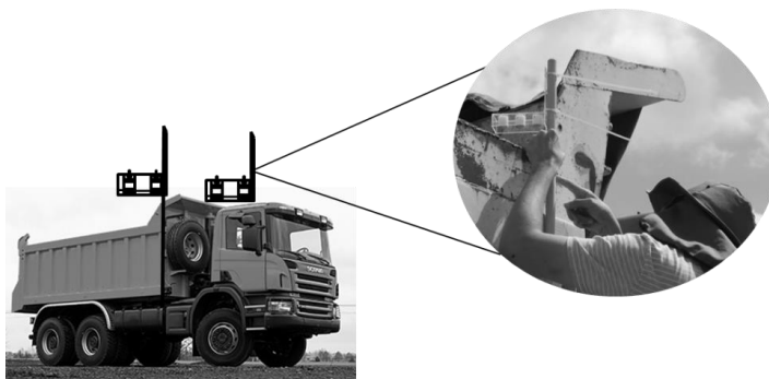
Figura 7: Amostragem de NO 2 e SO 2 no caminhão basculante durante o transporte da mistura asfáltica.
