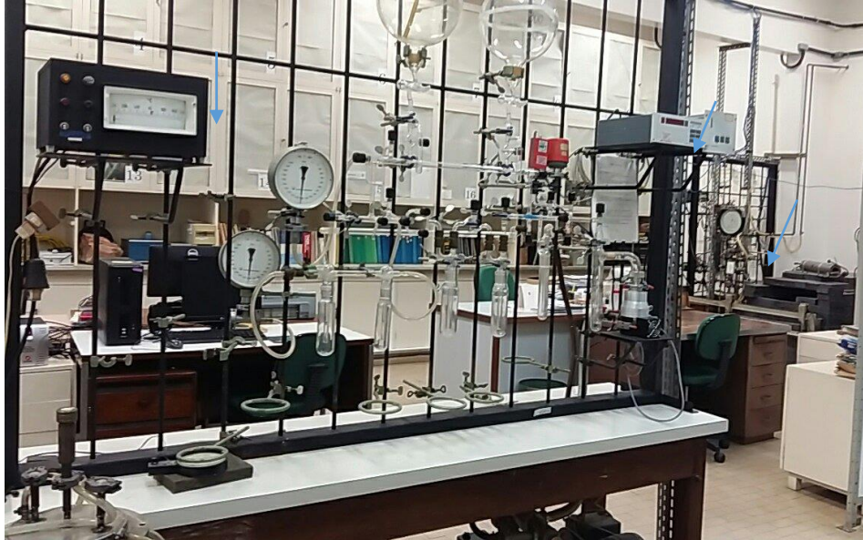
Figura 7 – Laboratório de Carbono-14 do Departamento de Física da UFC. a) Linha de preparação da amostra; b) Linha de admissão de gás no sistema de contagem; c) Detectores colocados dentro de um castelo de chumbo.
