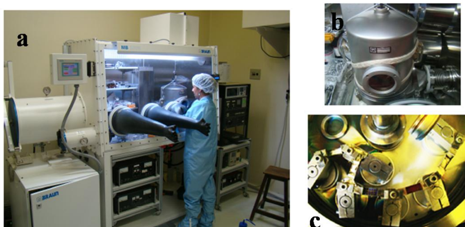
Figura 11 - (a) Sistema de deposição na glove Box MBraun (b) equipamento de alto vácuo Leybold (c) fontes de aquecimento.
