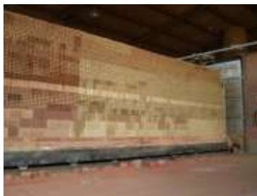
Figura 07. Forno vagão. Fonte: Congresso Brasileiro de Cerâmica. Cerâmica Paraguai capacidade 40.000 tijolos Umbara / Curitiba/ Pr.
