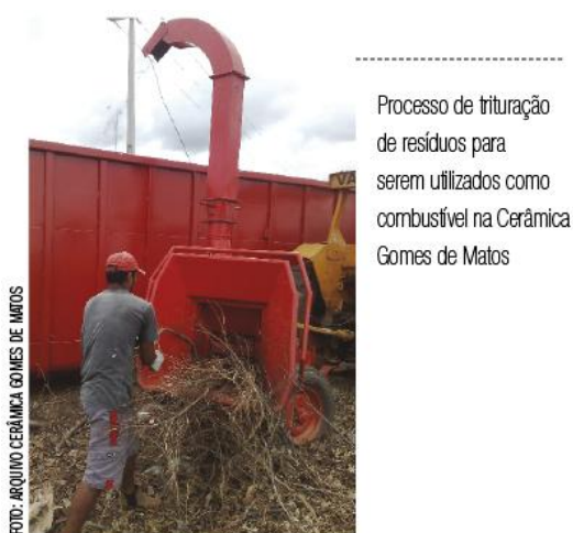
Figura 8. Resíduo sendo triturado que é utilizado no forno da cerâmica Gomes de Matos. Fonte CAMPOS, 2010
