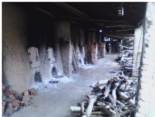
Figura 3. Forno Paulistinha mostrando as cinzas. Fonte própria.
