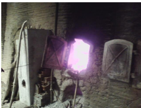
Figura 4. Fornalha aberta de um forno Paulistinha na cidade de Sobral. Fonte própria
