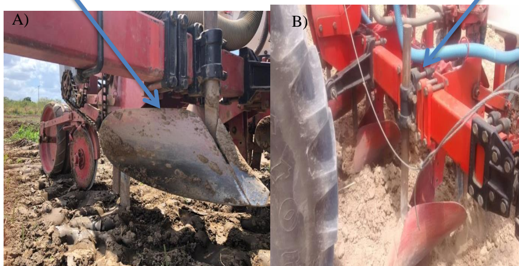
Figura 5 - Sulcador responsável pela formação do sulco e camalhão (A) e a haste de fixação (B)
