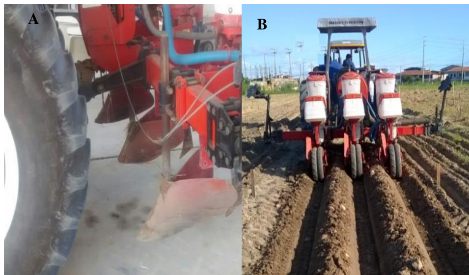
Figura 1- Mecanismo sulcador acoplado no chassi da semeadora adubadora (A), semeadura adubadora camalhoeira em operação no campo (B)
