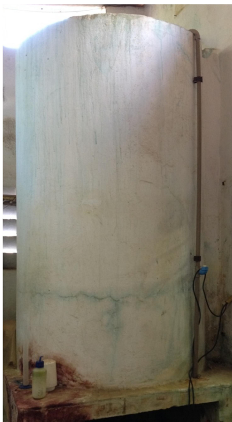
Figura 7 – Tanque de tratamento do efluente da indústria parceira.
