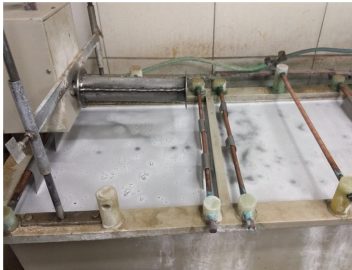
Figura 2 – Banho de decapagem da indústria de produção de bijuterias parceira deste trabalho.
