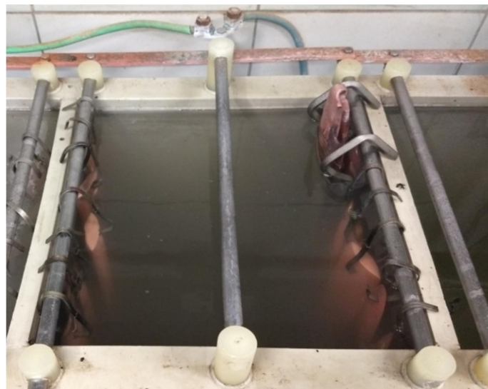
Figura 3 – Banho de “cobre ácido” da indústria de produção de bijuterias parceira.
