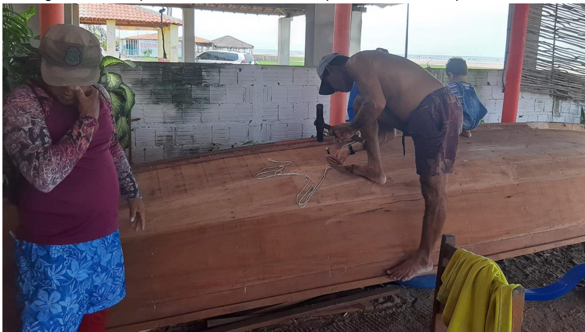
Figura 17 – Carpinteiro calafetando canoa para ser usada na pesca de curral
