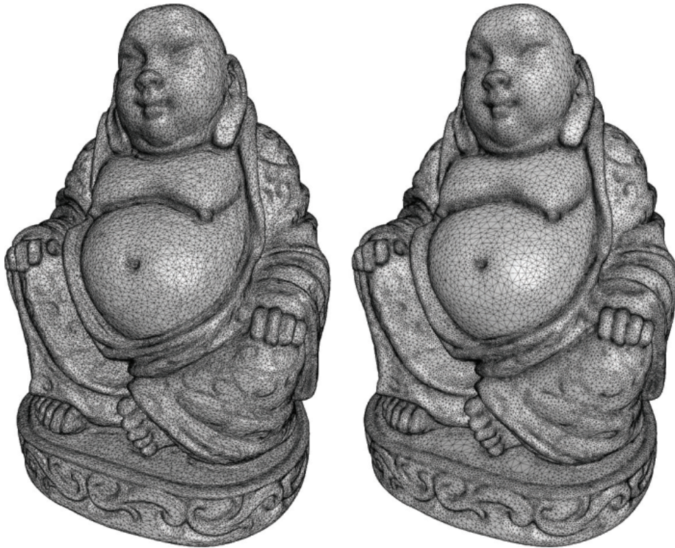
Figura 8 – Remeshing por refinação e filtragem Delaunay. A entrada (esquerda) é uma malha de superfície triangular irregular. A saída (direito) é uma malha de superfície triangular isotrópica.
