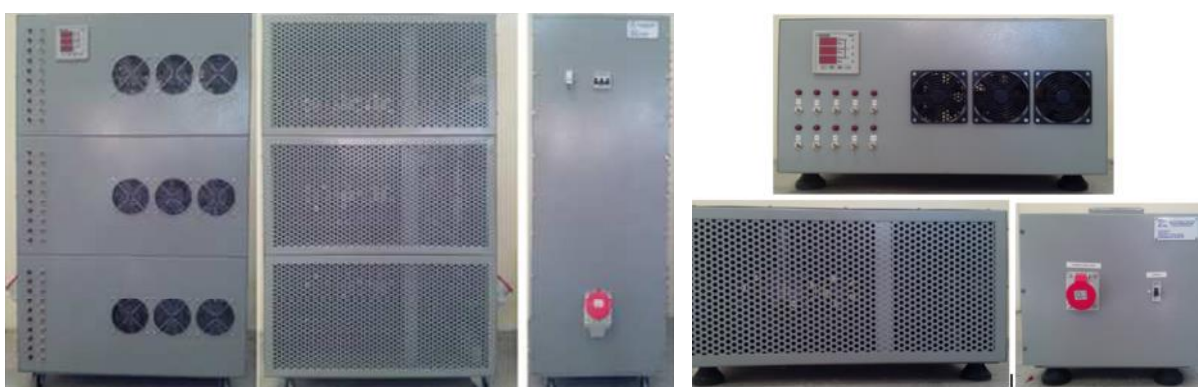
Figura 34 - Bancos resistivos trifásico (esquerda) e monofásico (direita) – vista frontal, posterior e lateral
