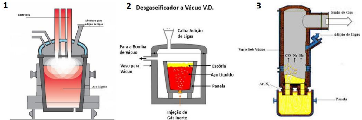
Figura 3 – Alguns equipamentos utilizados no refino secundário. Da esq. Para a direita: Forno Panela, Desgaseificador à Vácuo e Desgaseificador por Recirculação.
