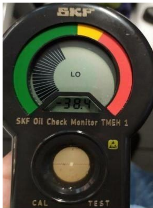
Figura 33 - Monitor de verificação de óleo
