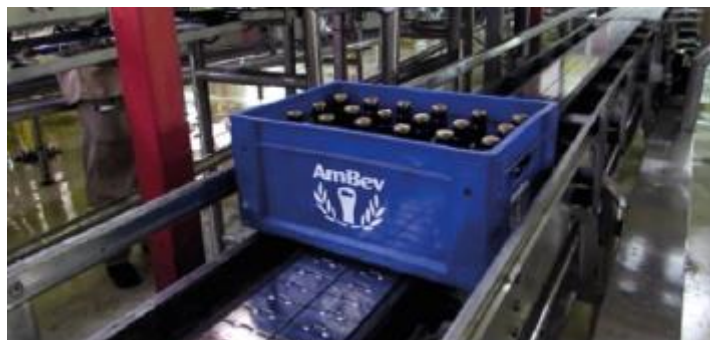
Figura 12 - Exemplo de corre transportadora metálica:
