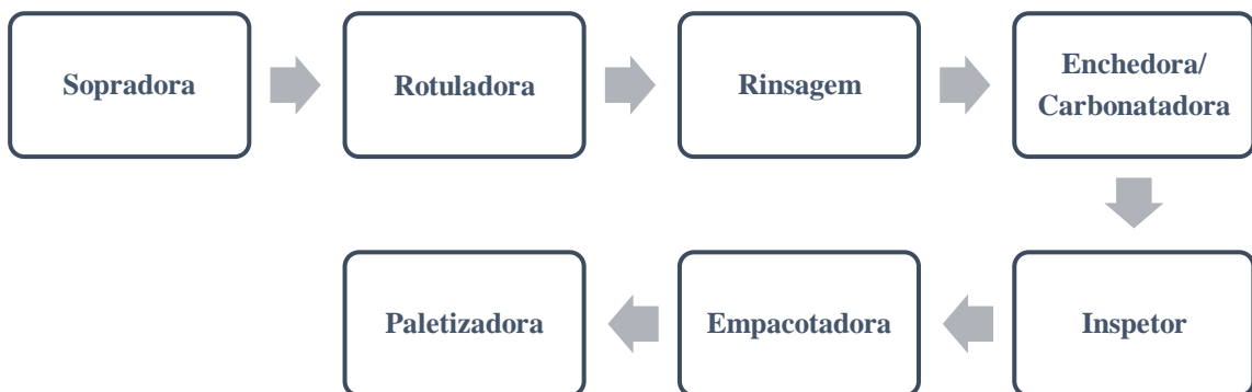
Figura 20 - Processo de envase na linha descartável 03.
