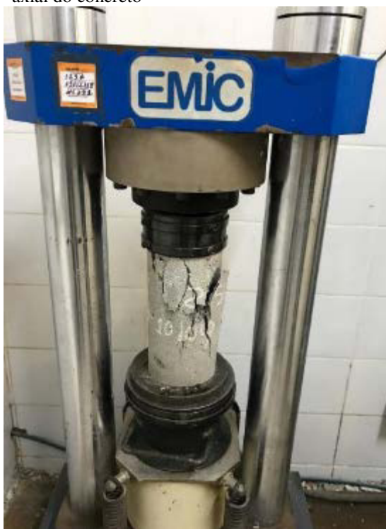
Figura 1 - Ensaio de resistência à compressão axial do concreto
