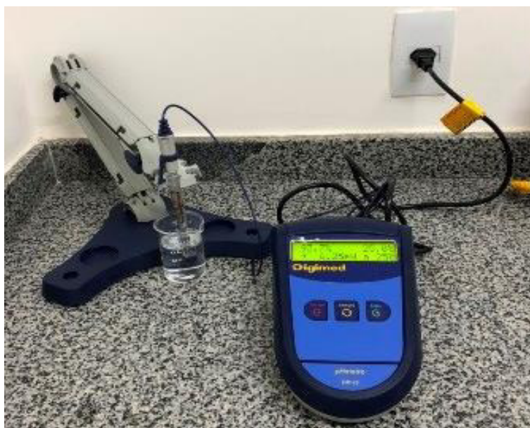
Figura 8: Condutivímetro utilizado para os ensaios de condutividade
