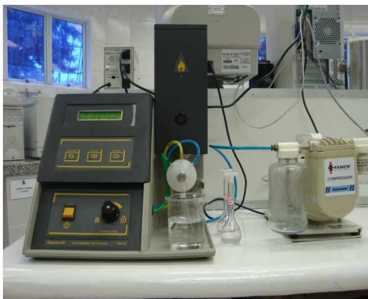
Figura 7: Fotômetro de chama utilizado para determinação do teor de sódio
