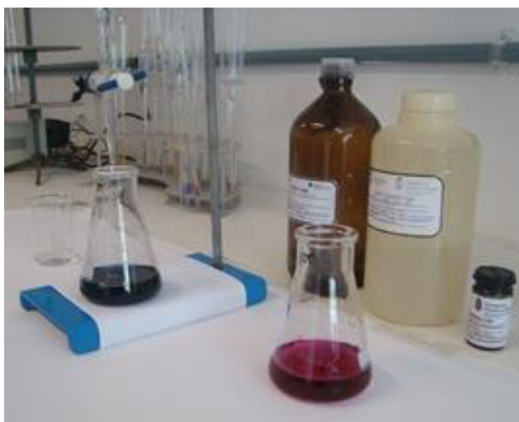
Figura 5: Volumetria de complexação – Dureza Total
