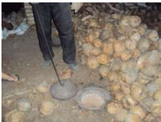
Figura 13. Queimador abre a tampa para colocar os resíduos do coco no forno. Fonte, própria, 2013.
