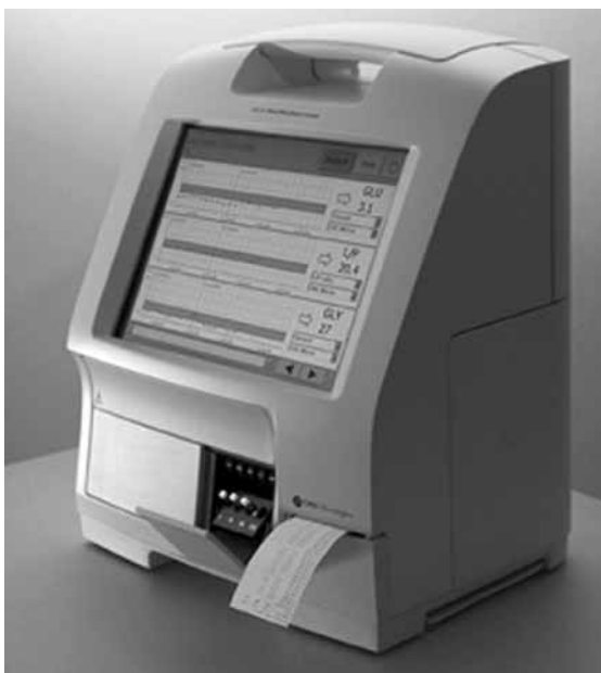
Figura 7. Analizador compacto portátil de microdiálisis cerebral.
