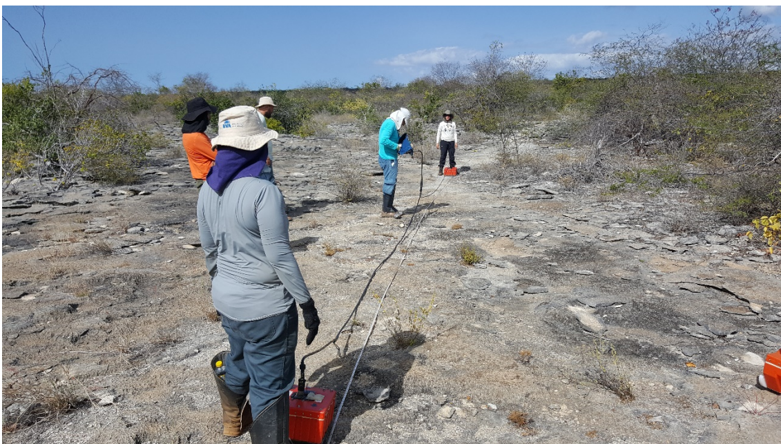
Figura 32 - Aquisição CMP com antena de 400 MHz.
