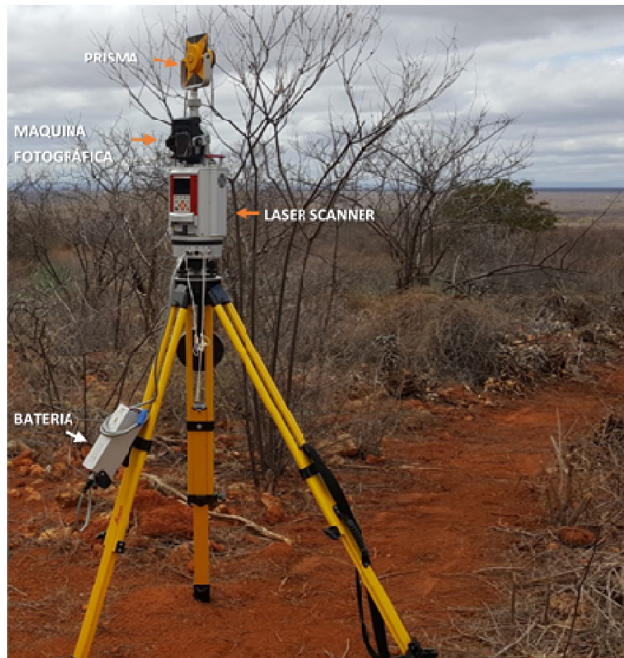
Figura 27 - Prisma topográfico fixado sobre o Laser Scanner.
