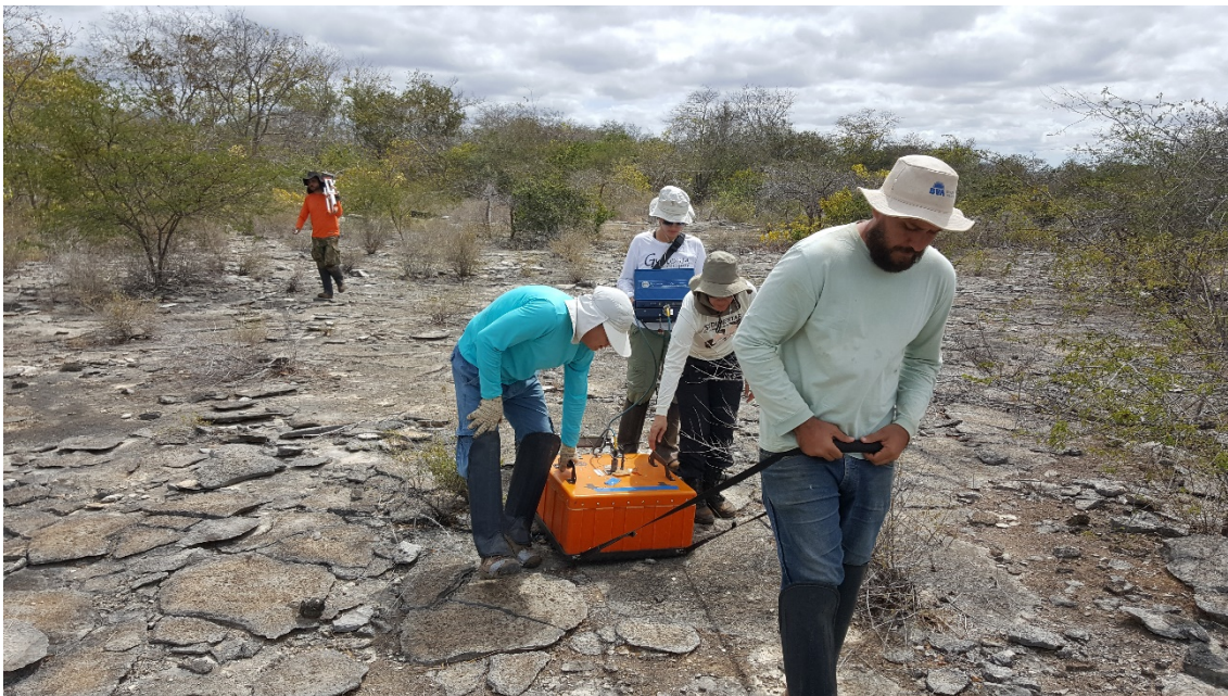
Figura 31 - Aquisição GPR técnica PR com antena de 200MHz.
