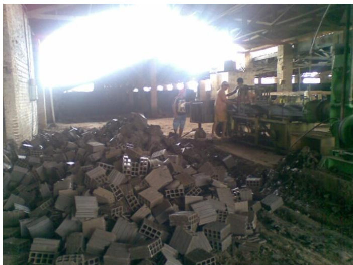
Figura 8: Acúmulo de blocos mal-conformados em chão de fábrica no município de Maracanaú no Ceará. Fonte: própria, 2012.
