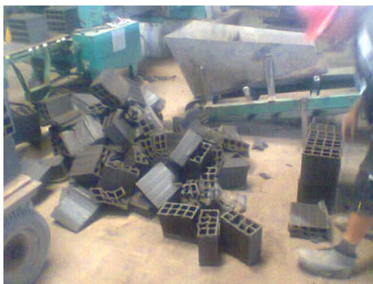
Figura 5: Exemplo de desperdício durante a extrusão em Sobral.
