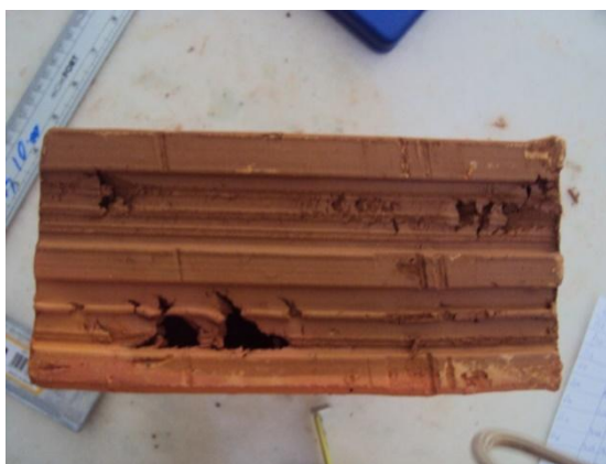
Figura 3: Peça defeituosa em decorrência de falhas na extrusão (6) .
