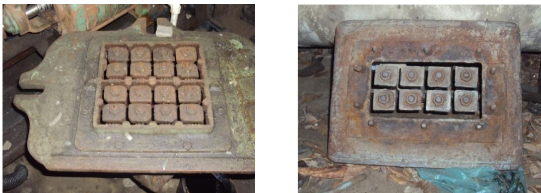
Figuras 9 e 10: Boquilhas sucateadas em fábricas do Ceará. Fonte própria, 2013.
