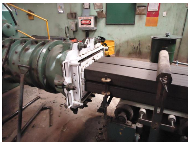
Figura 11: Extrusão de tijolos TF8 utilizando boquilha de quatro aberturas. Fonte própria, 2013.
