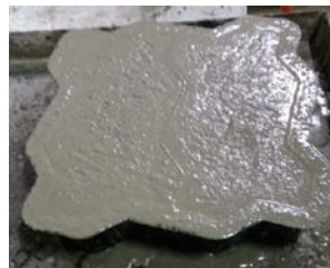
Figura 3 – Adensamento dos corpos de prova em mesa vibratória
