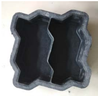
Figura 2 - Molde utilizado na moldagem dos Pavers
