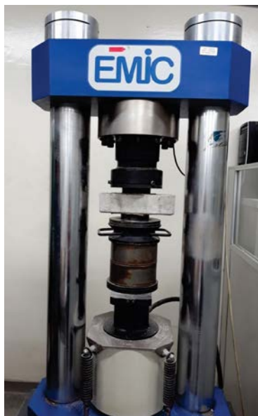
Figura 4 – Ensaio de resistência à compressão.
