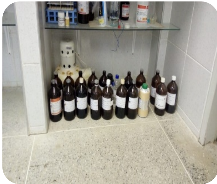
Figura 1. Resíduos coletados e armazenados em locais inapropriados no IFCE (Crateús), sem identificação e separação correta.
