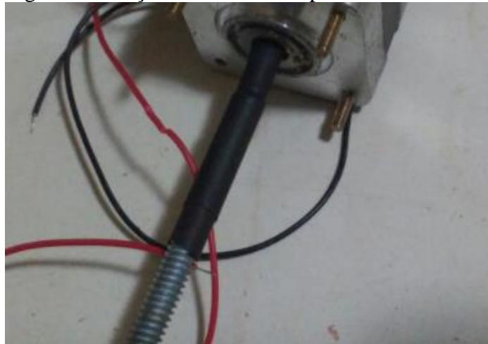
Figura 2 – Junção entre motor de passo e fuso
