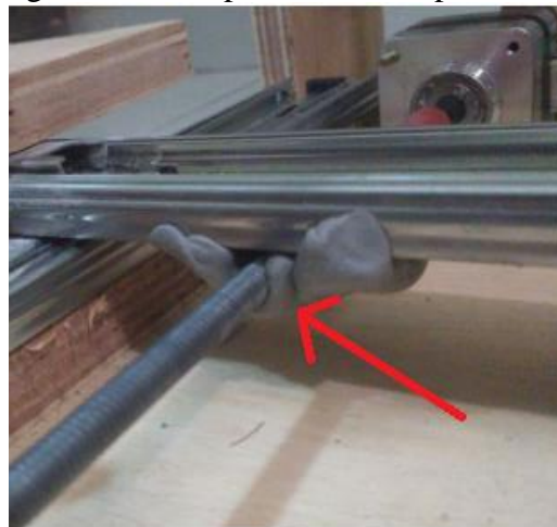
Figura 21 – Acoplamento das porcas à guia do eixo y.
