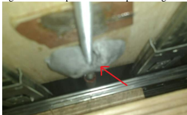
Figura 22 – Acoplamento das porcas à guia do eixo x.
