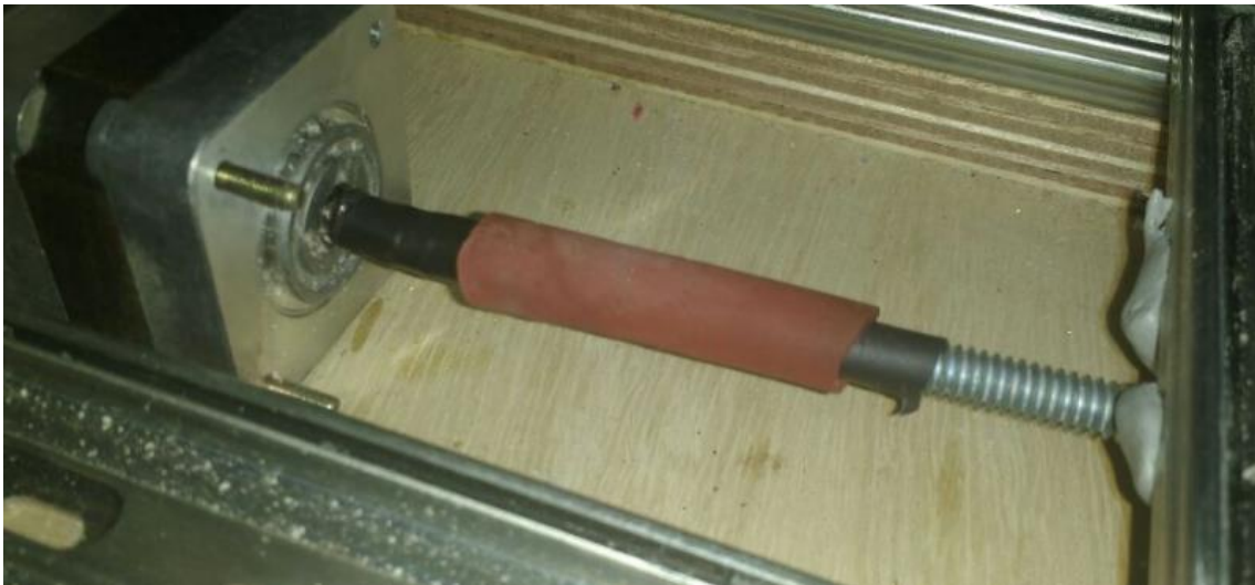
Figura 23 – Acoplamento do motor do eixo y ao seu fuso.
