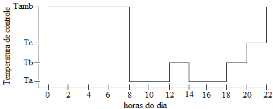
Gráfico 2: Perfil do controle de temperatura de uma zona exemplo
