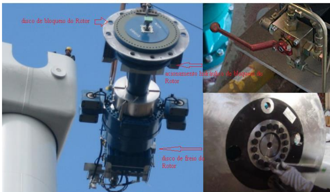
Figura 22 - Sistema hidráulico de freios e bloqueio do Rotor
