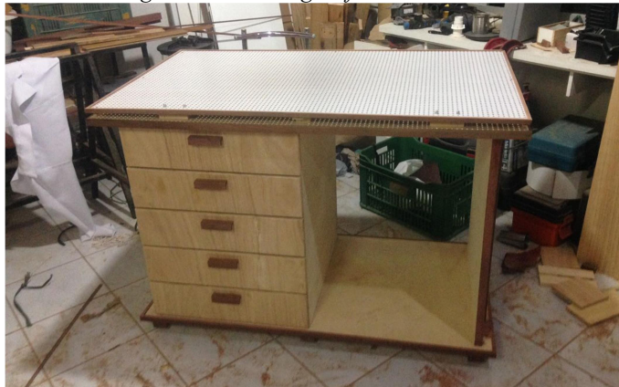
Figura 40 - Montagem final da bancada
