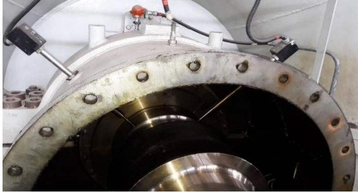
Figura 25: Arranjo físico dos sensores de proximidade em mancal radial.
