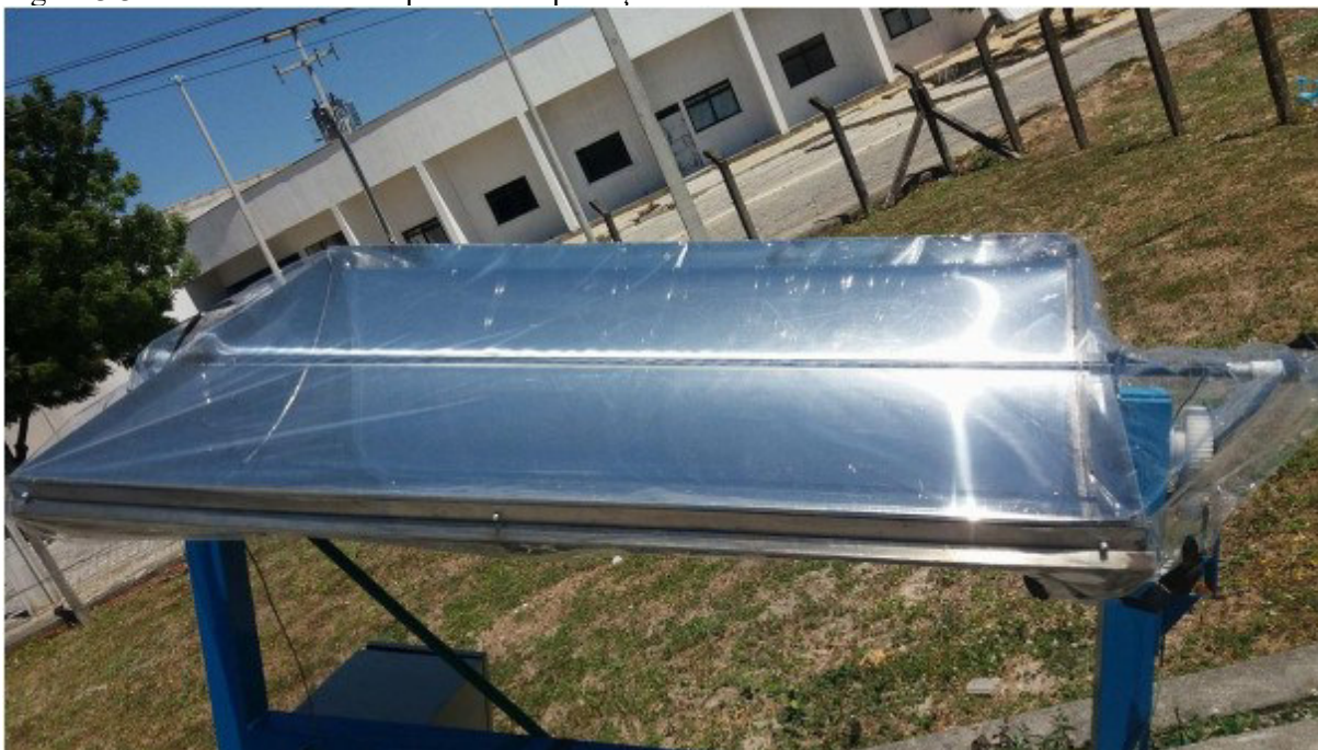
Figura 3.3 – Coletor solar com plástico de proteção
