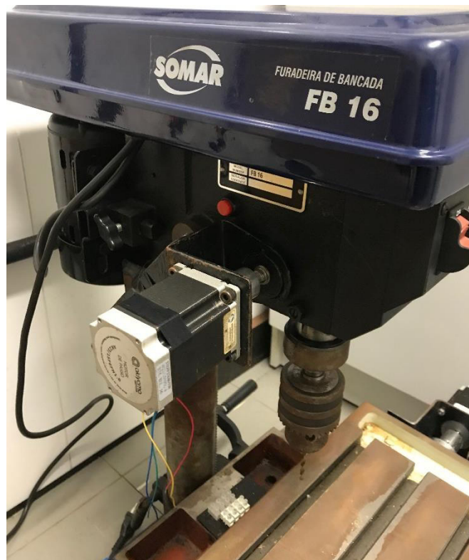
Figura 42 - Furadeira de bancada automatizada com o motor de passo.
