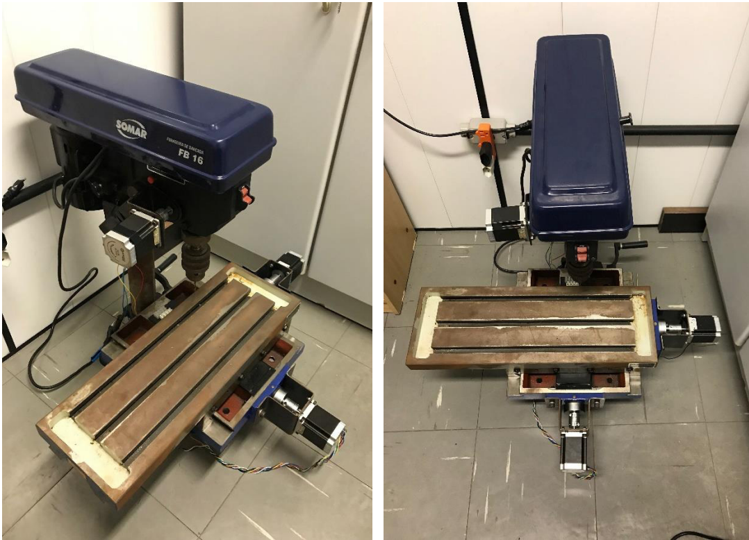
Figura 43 - Visão geral da furadeira automatizada integrada a mesa de coordenadas.
