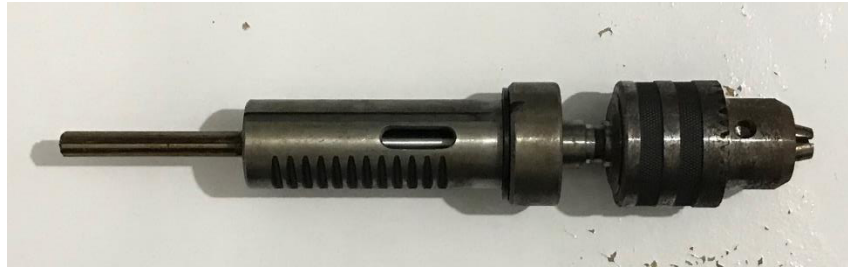
Figura 16 - Mandril da furadeira de bancada.
