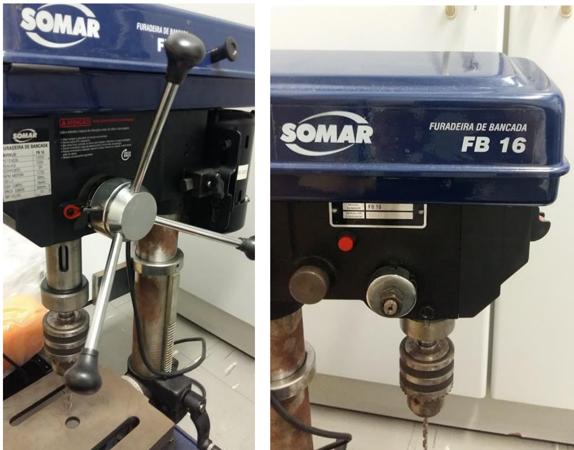
Figura 13 – Visão geral do sistema de movimentação vertical original.
