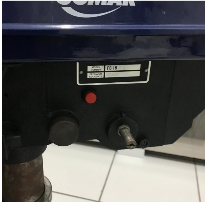
Figura 14 – Ponta do eixo de acionamento do mandril
