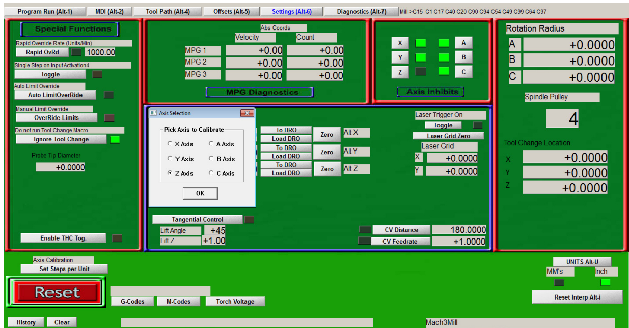
Figura 36 - Seleção do eixo Z para calibração.
