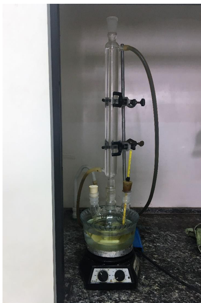
Figura 4: Processo de transesterificação do óleo de soja.
