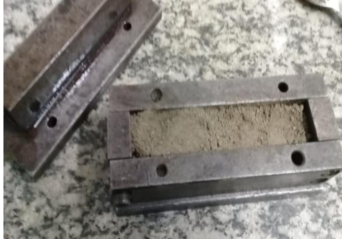
Figura 9 – Molde metálico utilizado para conformação dos corpos-de-prova.
