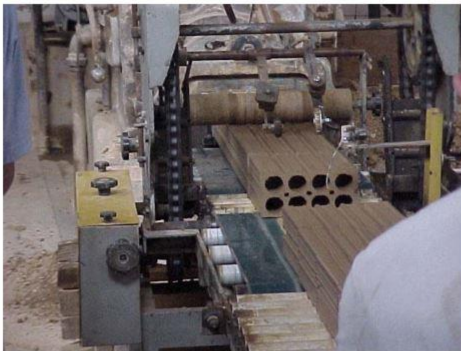
Figura 5 – Processo de extrusão de massa cerâmica.
