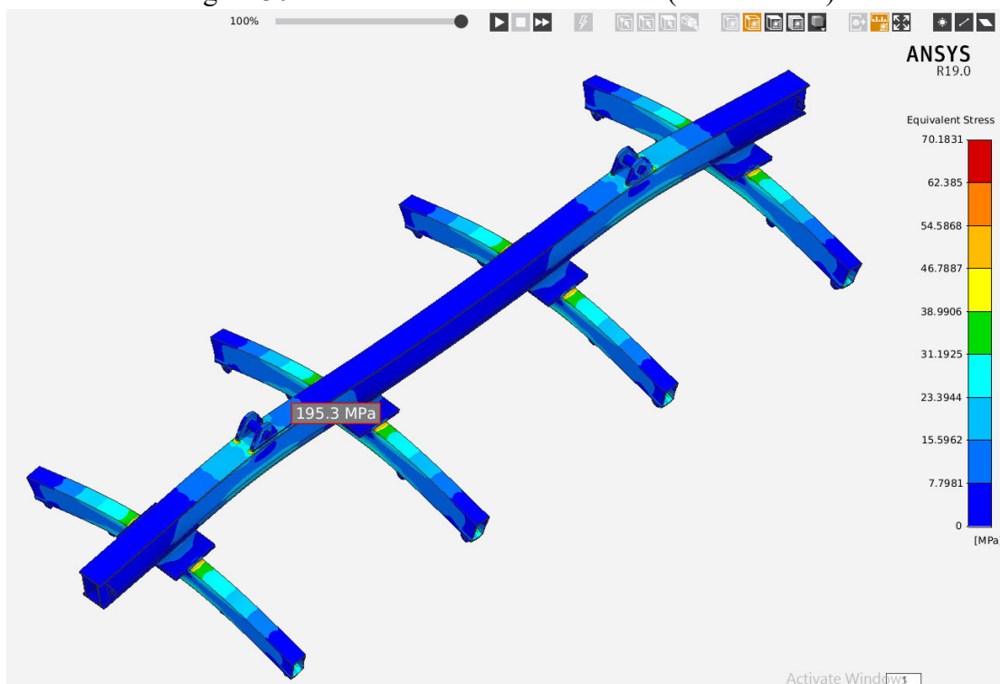
Figura 30 – Tensões atuantes na estrutura (Fonte: Autor)
