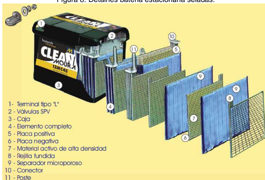
Figura 8. Detalhes bateria estacionária selada.
