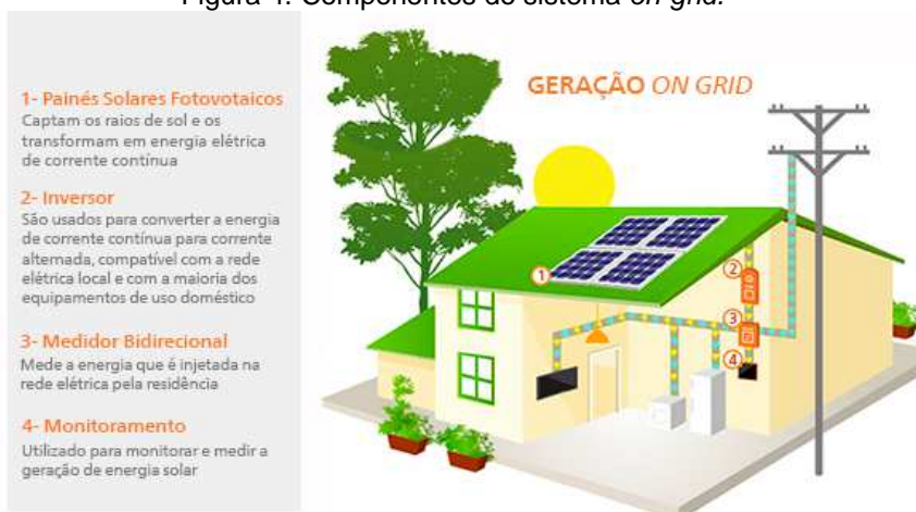
Figura 4. Componentes do sistema on-grid .
