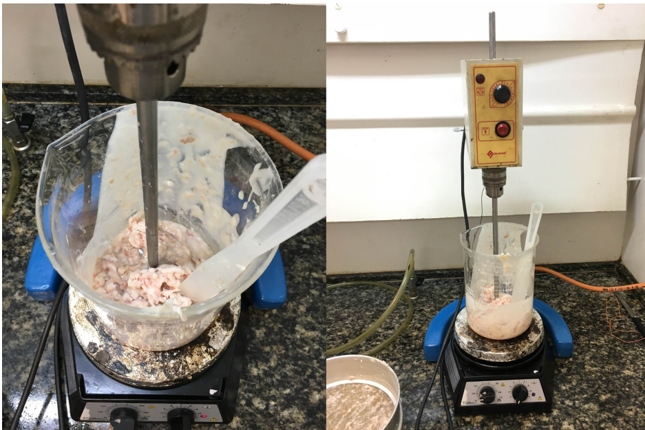
Figura 11 – Aquecimento/agitação da matéria-prima bruta
