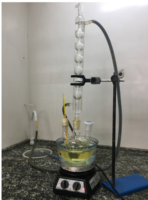
Figura 15- Aparato experimental para o processo de transesterificação
