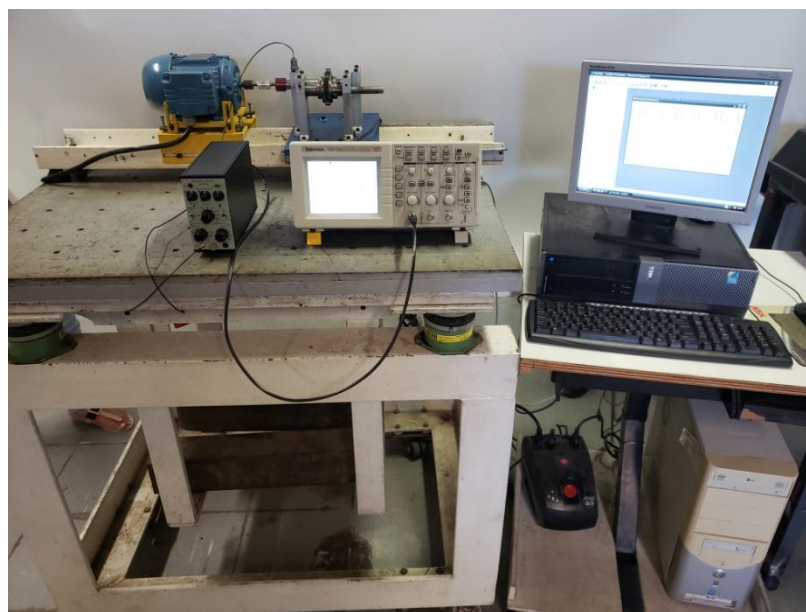
Figura 14- Bancada de teste de um par de engrenagens
