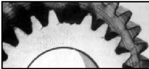
a) Ruptura por carga de impacto
