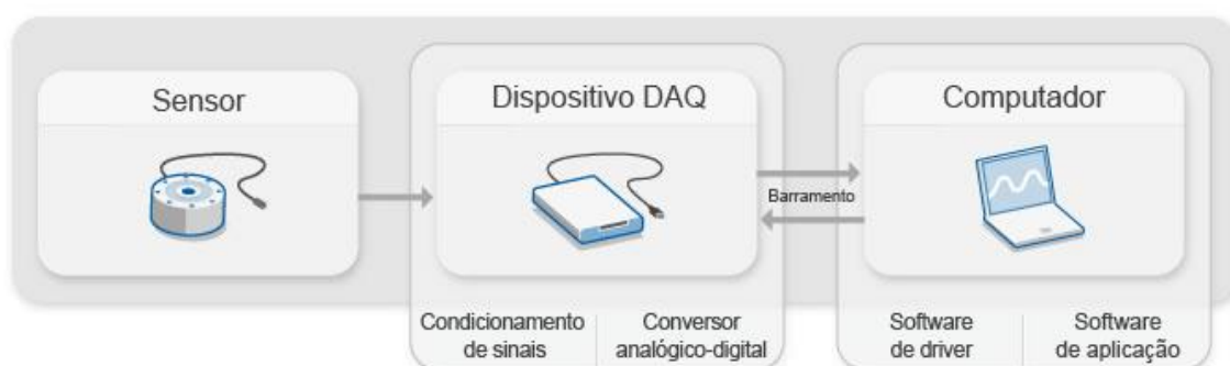
Figura 3 - Componentes de um sistema de aquisição de dados
