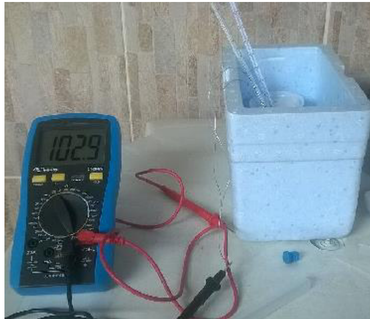
Figura 3.6 – Coleta de dados do PT100 para traçar as curvas de Resistência Elétrica x Temperatura.
