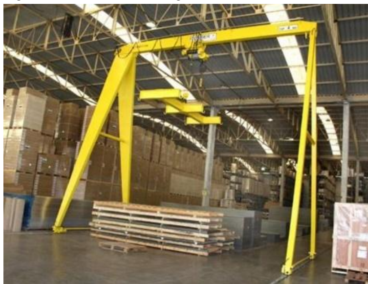
Figura 02 – Pórtico rolante univiga
