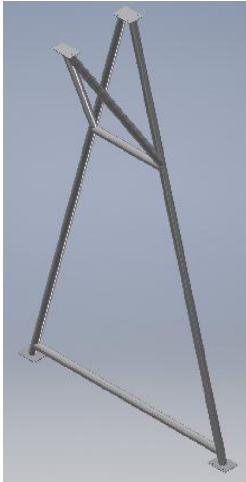
Figura 21 – Coluna com adição de novos tubos
