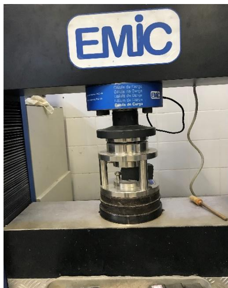
Figura 11 – Ensaio de resistência à compressão axial.
