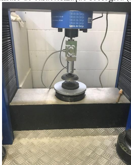
Figura 7 – Ensaio de caracterização reológica ( Squeeze-flow ).
