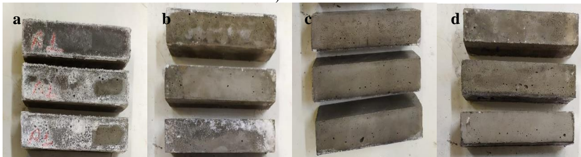
Figura 13 – Análise visual de eflorescência da argamassa A1: a) topo; b) lateral 1; c) lateral 2; d) base.
