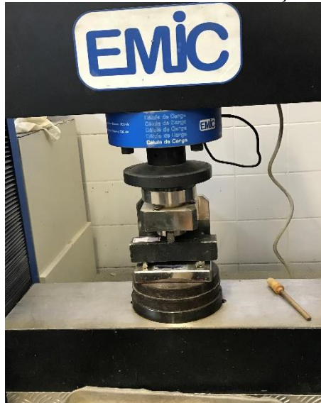
Figura 10 – Ensaio de resistência à tração na flexão.
