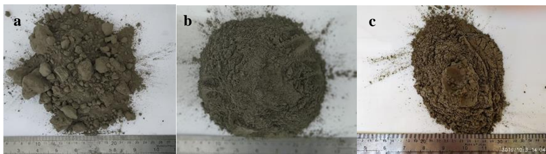
Figura 3 – Etapas da preparação da cinza volante: a) após secagem; b) após destorroamento; c) após peneiramento.
