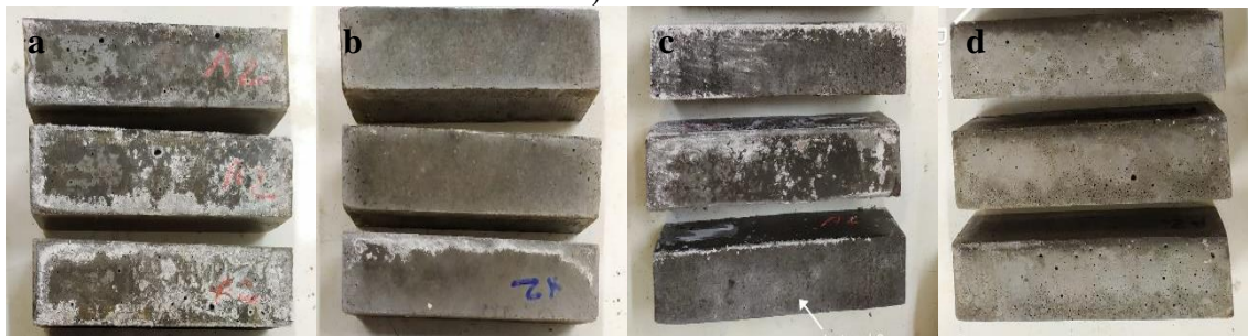
Figura 14 – Análise visual de eflorescência da argamassa A2: a) topo; b) lateral 1; c) lateral 2; d) base.
