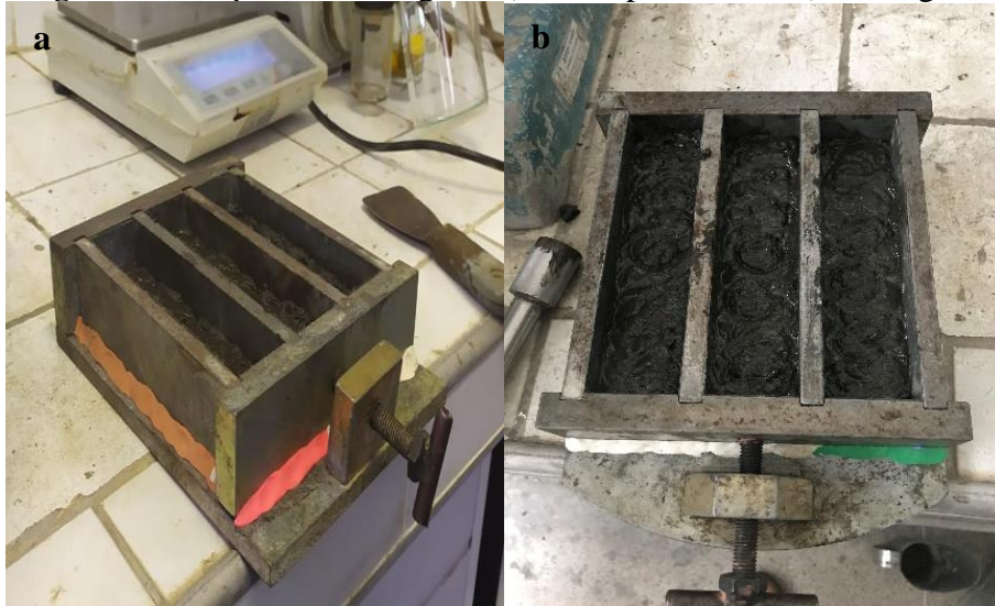
Figura 8 – Etapas da moldagem: a) fôrma prismática; b) moldagem.
