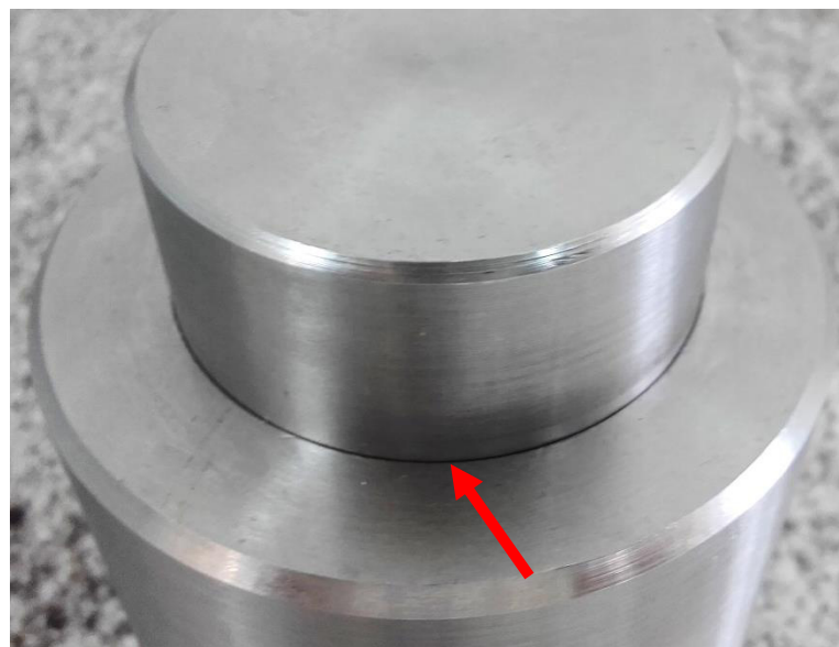
Figura 29 - Mostra a folga entre o pistão e o tubo da ordem de milésimos de milímetro
