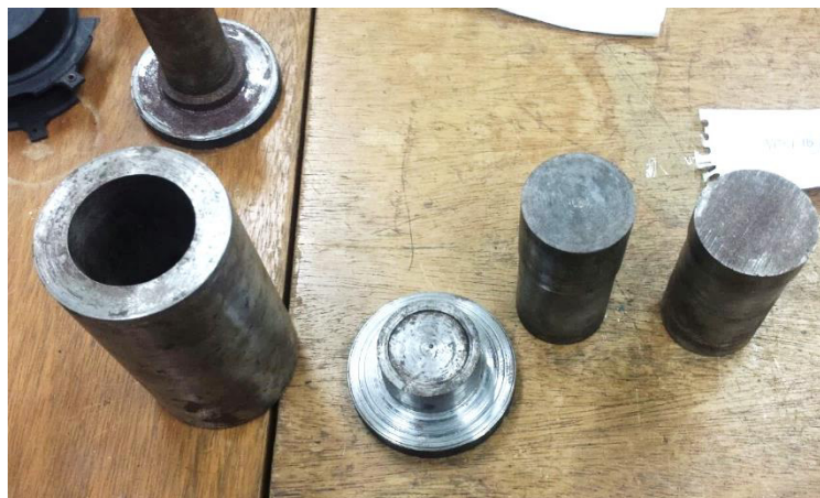
Figura 23 - Peças desenvolvidas pelo LAFFER para extração de óleo de sementes de maracujá
