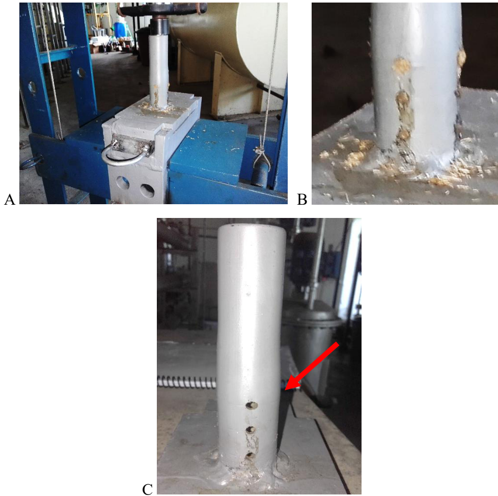
Figura 20 - Mostram a deformação sofrida pelo tubo de Ø25mm (A, B e C)
