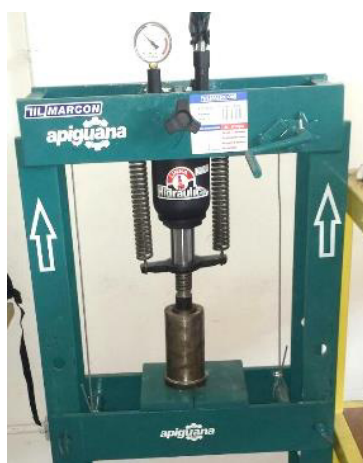
Figura 24 - Posicionamento do molde cilíndrico desenvolvido pelo LAFFER numa prensa hidráulica
