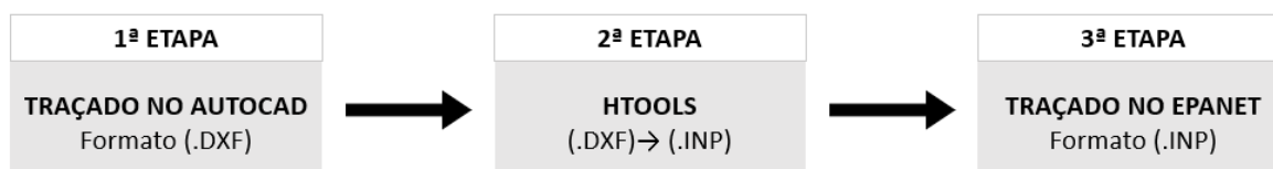
Figura 2 - Etapas da modelagem hidráulica. Fonte: Autor, 2018.
