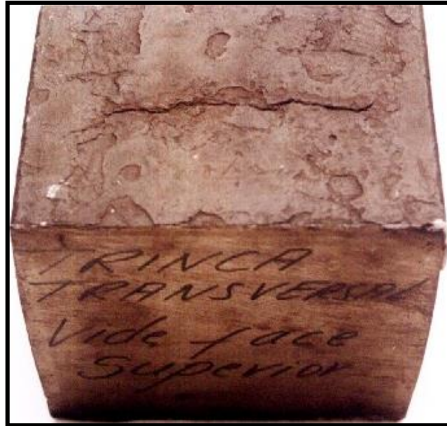
Figura 2.9. Trinca transversal na face superior de em um tarugo de seção 130X130 mm
