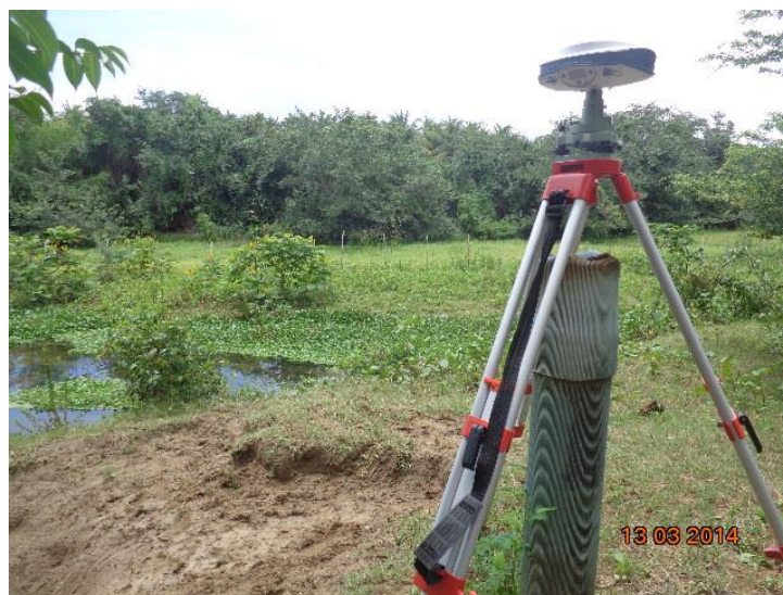
Figura 13 - Obtenção de coordenadas UTM dos poços com GPS geodésico no PICP - CE.
