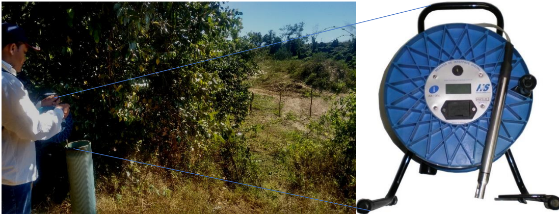
Figura 12 - Medição do nível estático, poço raso, PICP, Ceará
