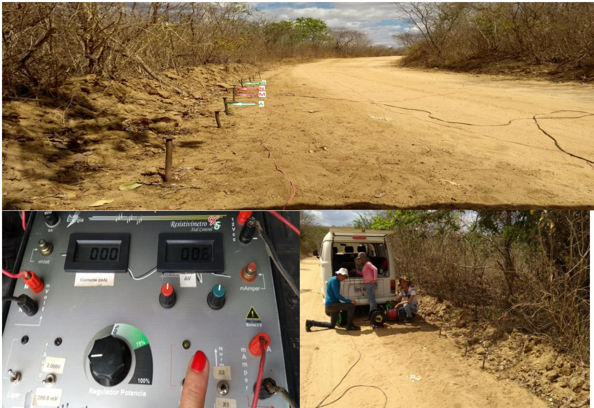
Figura 20- Levantamento geofísico - SEV no PICP - Ceará
