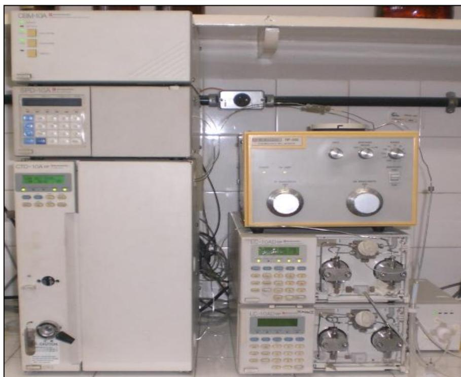
**Figura 7 - Aparelho de HPLC (High Performance Liquid Chromatography). Laboratório de Neurofarmacologia do Departamento de Fisiologia e Farmacologia da Universidade Federal do Ceará (UFC).**
