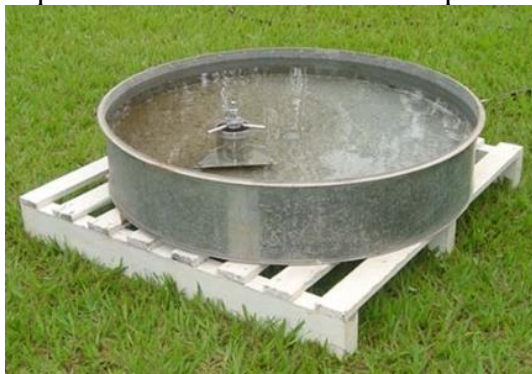
Figura 2 - Tanque classe A instalado de forma padrão, sobre o solo
