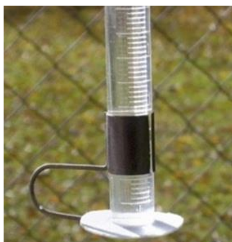
Figura 4 - Evaporímetro de Piché
