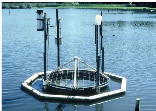
Figura 3 - Tanque classe A instalado sobre o reservatório
