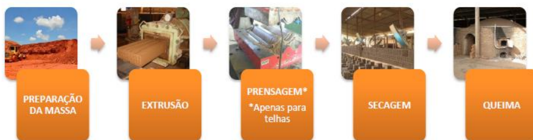
Figura 2 – Macro etapas do processo de produção de cerâmica vermelha
