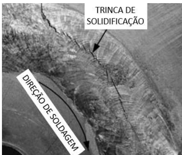
Figura 1. Trincas de solidificação presente em liga de alumínio
