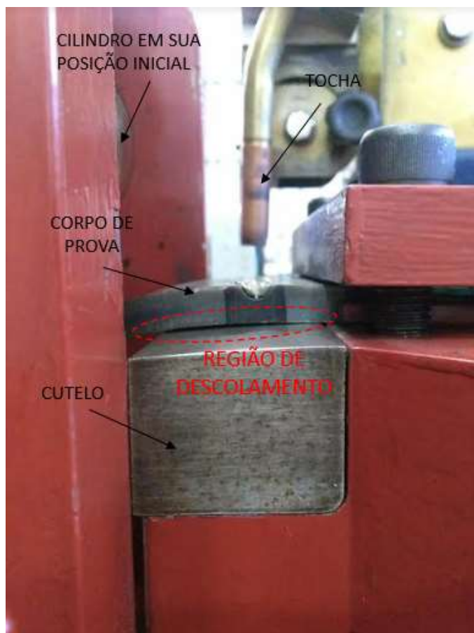
Figura 24. Região de descolamento do corpo de prova do cutelo após a retirada da carga aplicada no ensaio Trans-Varestraint
