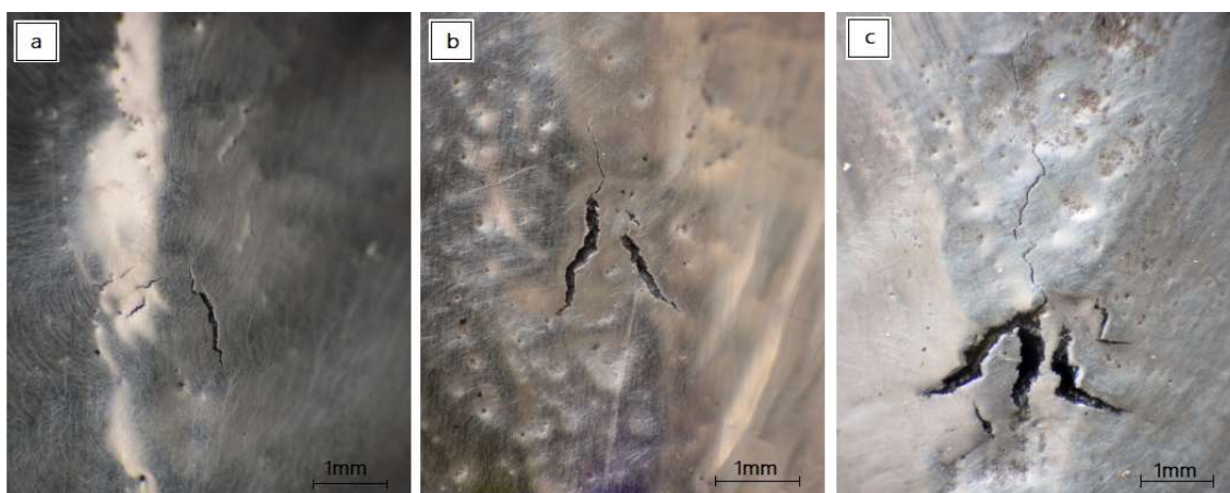
Figura 35. Trincas formadas no ensaio Trans-Varestraint em corpo de prova fabricado com metal base de aço 1045, soldado com arame Hastelloy C276, energia igual à 0,75 kJ/mm e deformação igual a: a) 0,5%, b) 1% e c) 3%
