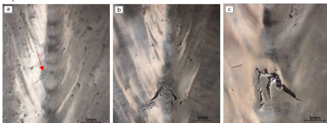
Figura 30. Trincas formadas no ensaio Trans-Varestraint em corpo de prova fabricado com metal base de aço A36, soldado com arame Inconel 625, energia igual à 0,75 kJ/mm e deformação igual a: a) 0,5%, b) 1% e c) 3%
