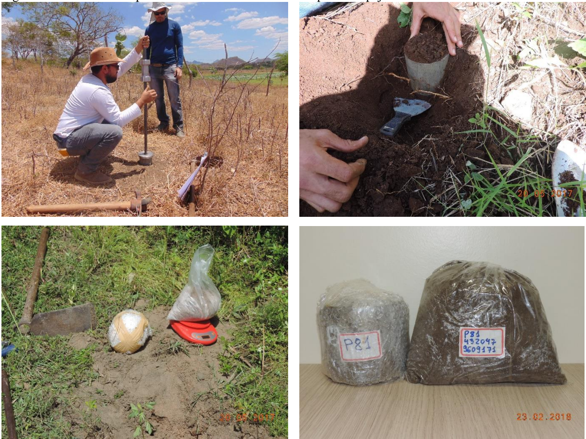
Figura 12 – Bate estaca e procedimentos de coleta no município de Itapajé/CE
