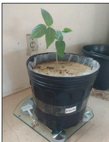
Figura 3 - Pesagem dos vasos antes da irrigação para determinação da água aplicada.
