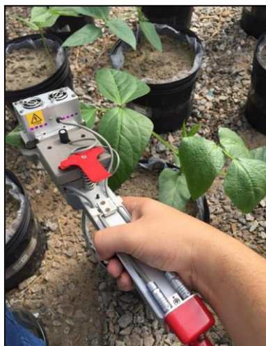
Figura 7 - Utilização do IRGA para análise de trocas gasosas.
