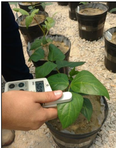
Figura 6 - Medição do índice relativo de clorofila através do SPAD.
