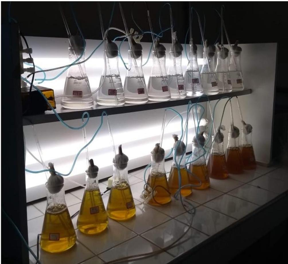
**Figura 10** - Diluições do efluente de vísceras de tilápia utilizado no cultivo de microalgas. A- 25% de efluente de víscera de Tilápia; B- 50% de efluente de víscera de Tilápia; C – 75% de efluente de víscera de Tilápia; D – 100% de efluente das vísceras de Tilápia, PADETEC-UFC, Fortaleza CE, 2019.
