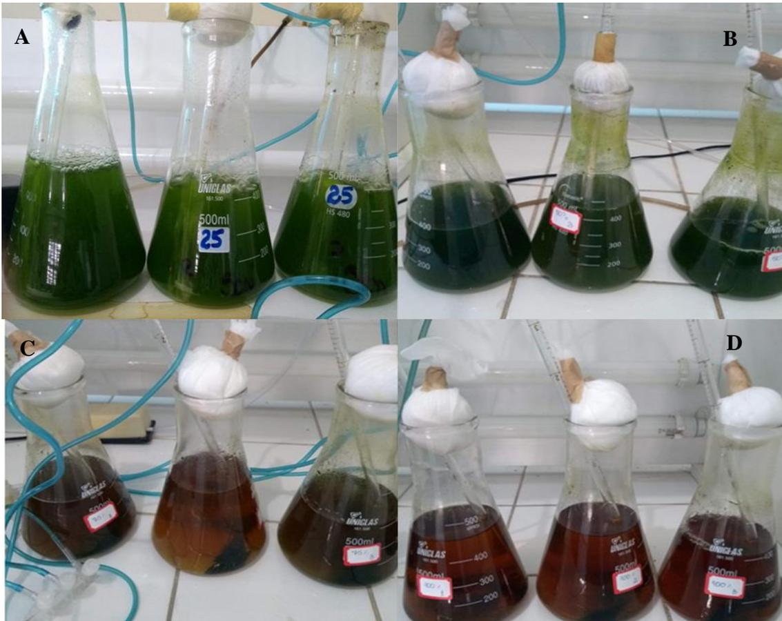
A contagem foi realizada semanalmente até 35 dias após inoculação, em câmara de Neubauer e absorvâncias analisadas em espectrofotometria UV. Os dados foram colocados em uma curva de crescimento (concentração celular x dias de cultivo), adotada como ferramenta padrão para análise do crescimento (LIRA *et al.*, 2012), e para a construção da reta de regressão no programa Excel.
