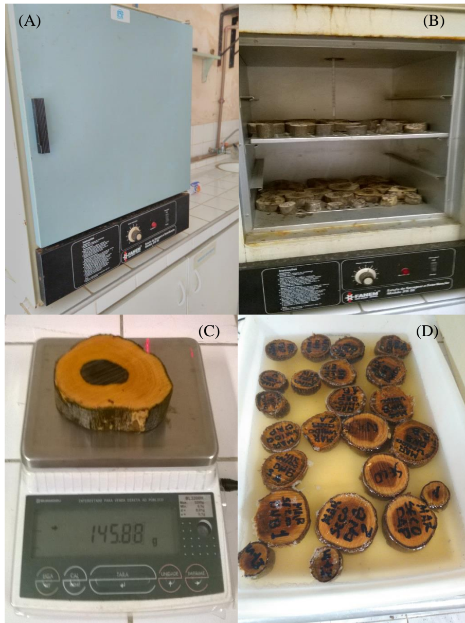
Figura 6 - Esquema do procedimento de secagem dos discos de madeira das espécies analisadas. Estufa de secagem (A); estufa com os discos para secagem (B); balança de precisão (C); amostras sendo saturadas (D).
