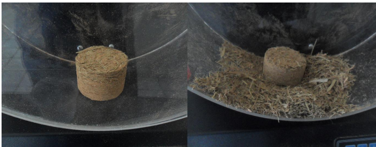
Figura 30 – Briquete de blenda antes e após a realização do ensaio de friabilidade.
