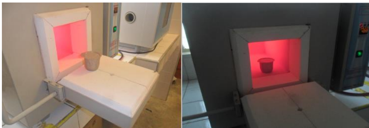
Figura 15 – Cadinho de Platina e Forno Mufla (Teor de Voláteis).
