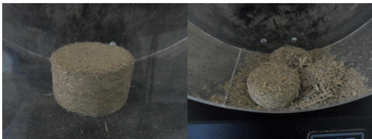
Figura 29 – Briquete de palha antes e após a realização do ensaio de friabilidade.
