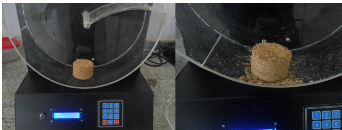
Figura 28 – Briquete de talo antes e após a realização do ensaio de friabilidade.
